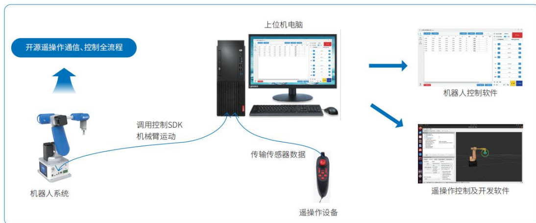
机械臂与遥控操作系统构成图
