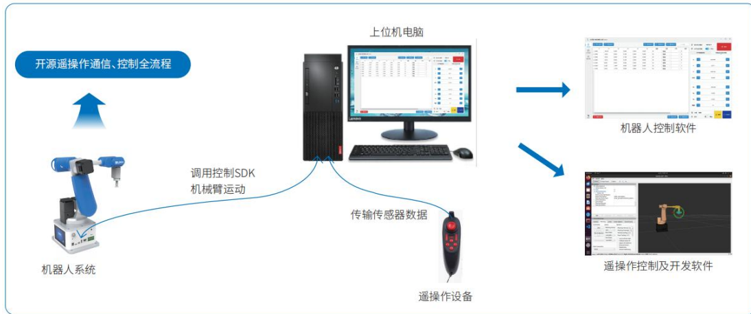
机械臂与遥操作系统构成图
